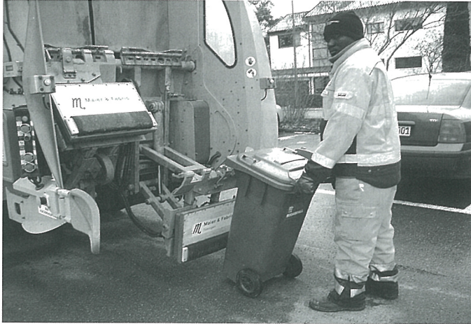
Bioabfallsammlung mit Detektionssystem. Foto: Maier & Fabris GmbH
